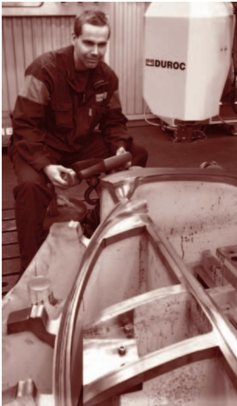
Laserhårdning har successivt blivit en standardiserad ytbehandlingsmetod i allt fler verktygsapplikationer hos Volvo PV.
