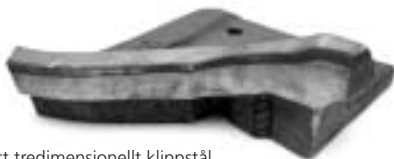
Ett tredimensionellt klippstål där klippeggen laserhårdas.
