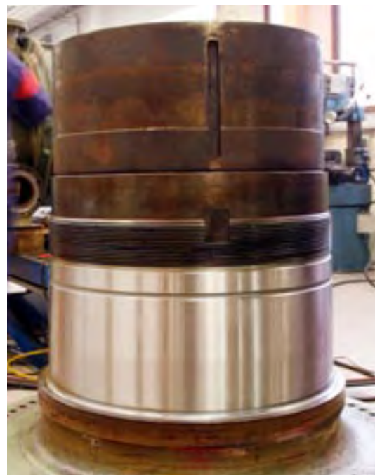
Duroc Engineering levererar underhåll av slitageutsatta komponenter. På bilden en lasersvetsad sugvalsgavel till M-real Husum-Wifsta.
