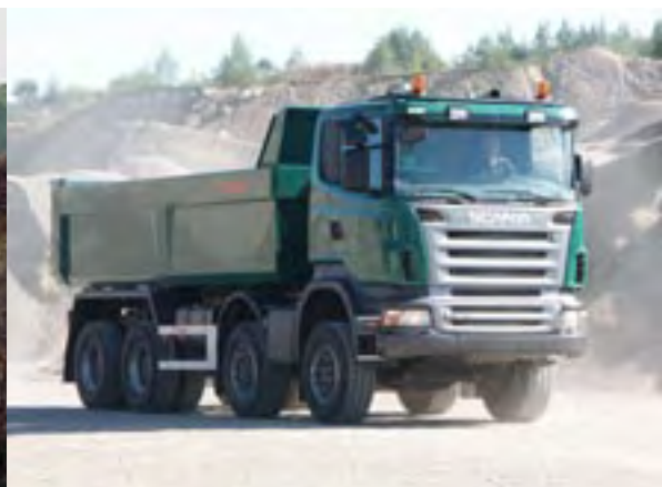
Laserhybridsvetsade plåtar med högre hållfasthet i upp till tre meters bredd gör att kunderna kan reducera tjockleken på plåtarna med omkring två millimeter, vilket på ett normalt lastbilsflak gör mer än 200 kg plåt.
